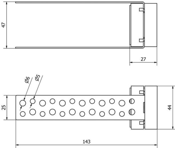
1. 用螺钉穿过中心孔将VT-AWS元件紧固，孔的直径为6mm。压缩固定，直到圆柱体距离与现有壁接触为止。
